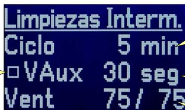
Si la casilla se marca, también se activará la salida del ventilador auxiliar (FC)
