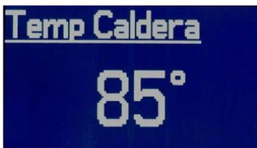
Las bombas de circulación pueden funcionar si se dan las condiciones para ello, incluso si el quemador se encuentra apagado. Esto permite que el resto de la energía térmica del agua contenida en la caldera pueda ser utilizada.
