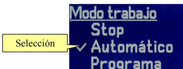
Por medio de los botones “▲” y “▼” se desplaza arriba o abajo el indicador de selección del modo deseado. Al volver a presionar **F** se memoriza el modo marcado anteriormente.
