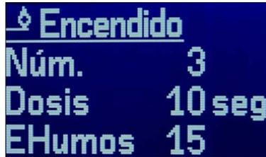
**Ajuste de la fase de encendido** -
