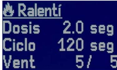
**Quema apagado** (Apagado suave) – Cuando el termostato ambiente alcanza la temperatura programada, estando el controlador en modo Calefacción, el quemador disminuye suavemente la potencia y si el termostato continua activado, se apaga. El quemador funcionara en cada nivel el tiempo programado en el siguiente menú, disminuyendo su potencia al siguiente nivel. El quemador sigue funcionando en el nivel que se encuentra actualmente, no aumenta su potencia.
