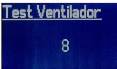
**Test Extractor**– Test de velocidad del ventilador extractor de humos. La potencia del extractor puede aumentarse o disminuirse con los botones ▲ y ▼. Esta función está limitada en el tiempo y se apaga automáticamente.
