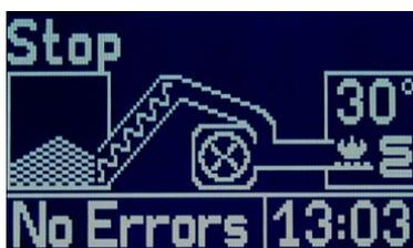
Después de esto, un ciclo de apagado y limpieza del quemador, comenzara automáticamente.
