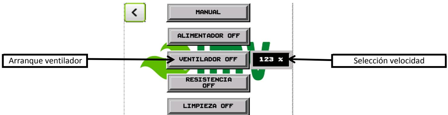
Para arrancar el ventilador pulsamos **VENTILADOR OFF**, este se pone en funcionamiento y no lo volvemos a pulsar para pararlo.
