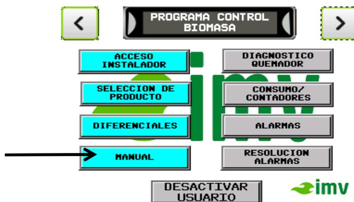
Nos aparece la pantalla de funcionamiento manual de todos los elementos del quemador. Si la tecla de arriba nos pone **AUTOMATICO** la pulsamos hasta que nos indique **MANUAL**. Entonces ya esta a punto para funcionar en manual.
